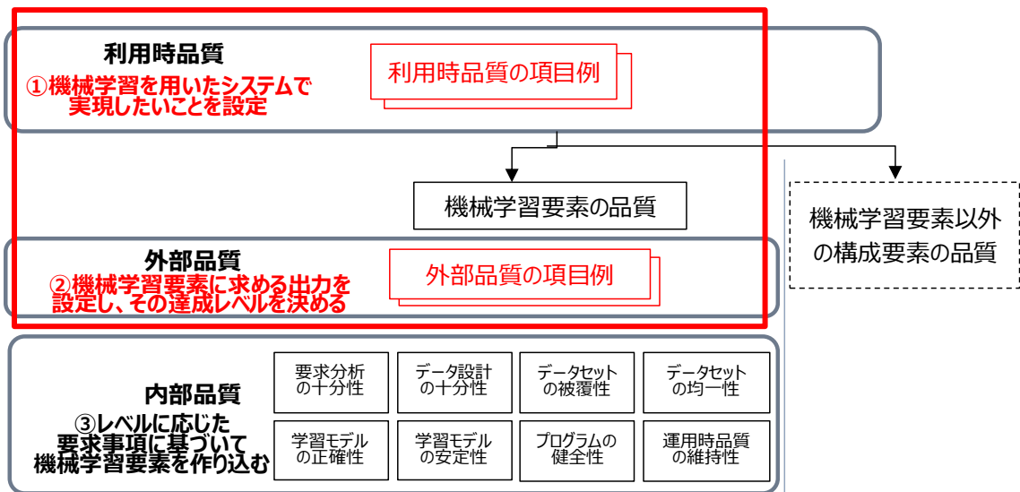
図 3-20 階層的な品質確保における利用時品質・外部品質項目設定の位置づけ
